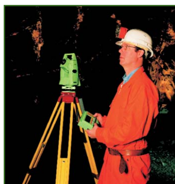
Рис. 6 Съемка с помощью тахеометра с сервоприводом
